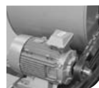
18 Салазки для регулирования натяжения ременной передачи
